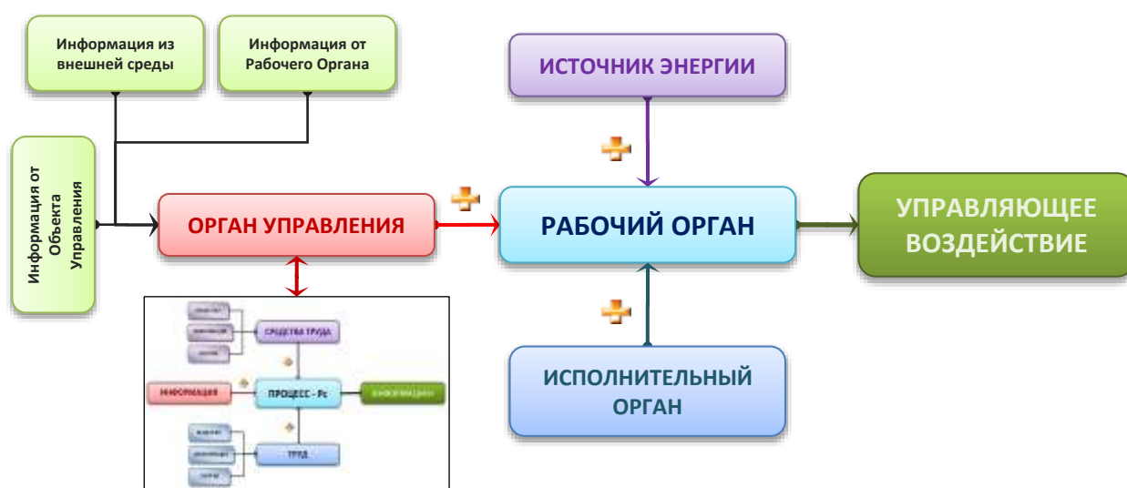
Рис.4 Принципиальная схема СИСТЕМЫ УПРАВЛЕНИЯ типа (И-Э)
